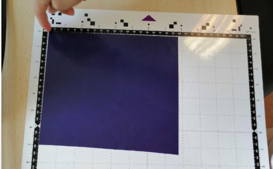
Placer le support adhésif dans la machine et appuyer sur le bouton :
